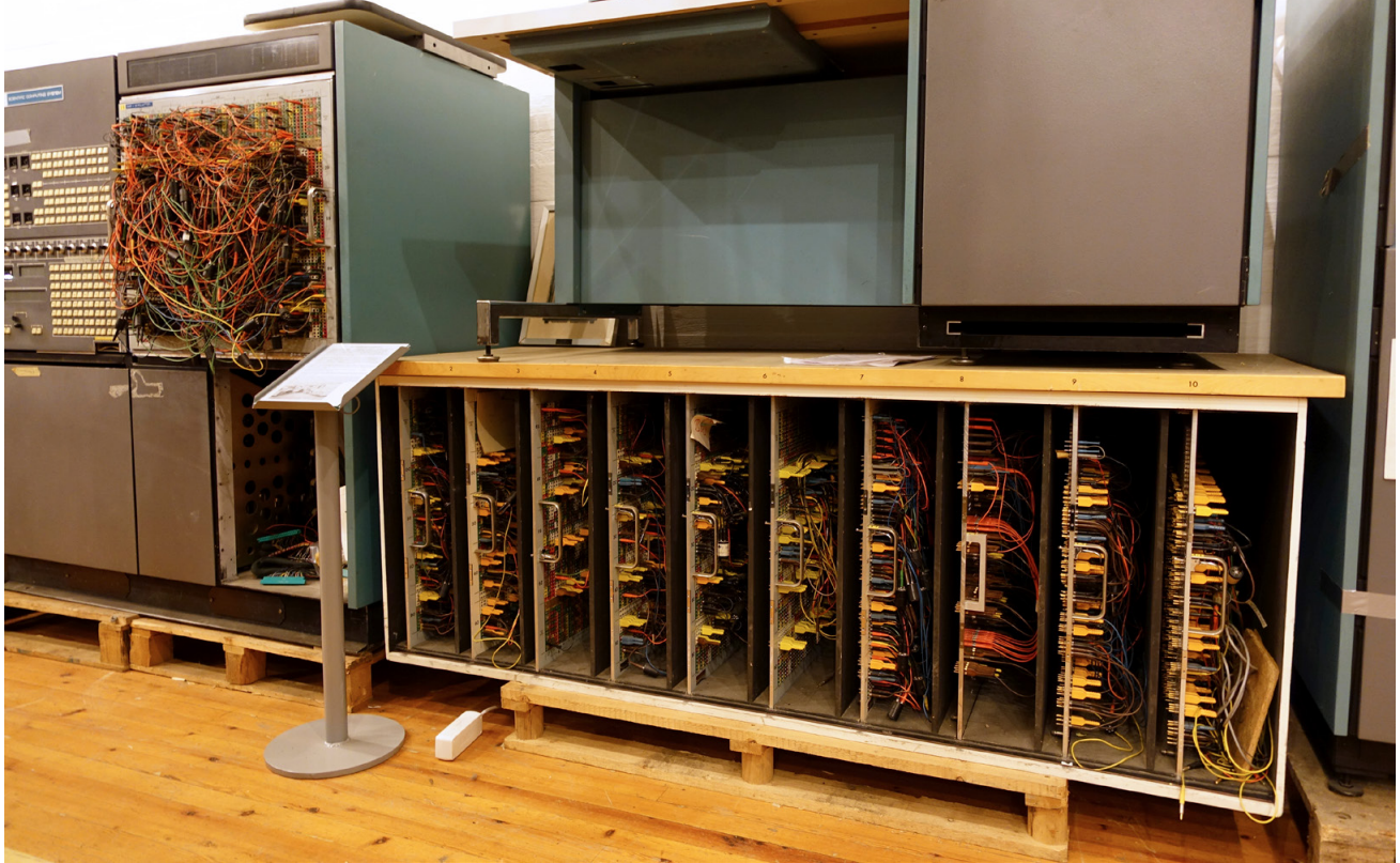
EAI 640/680 -analogi-digitaali-hybriditietokone. Kuvan isot kytkentälevyt ovat vaihdettavia analogisia "ohjelmia". Käytössä oleva "media" on kuvassa vasemmalla ylhäällä. (Kuva: Janne Sirén)
